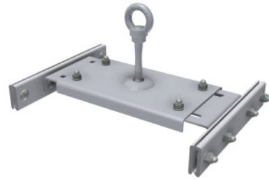
Kuva 2: Konesaumakattovaihtoehto (saumaleveys 330–460 mm)
